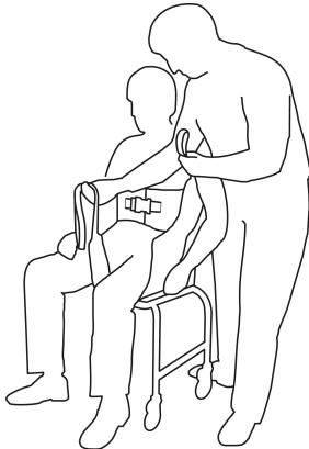
Legen Sie den Gurt so am Rücken des Patienten an, dass er sich direkt unter den Schulterblättern und über der Gürtellinie befindet. Befestigen Sie den Gurt mit der Schnalle vorne um den Patienten. Der Gurt muss nicht eng sitzen. Beim Gurt mit Schnalle handelt es sich um eine Positionierungshilfe und nicht um einen Rückhaltegurt.
