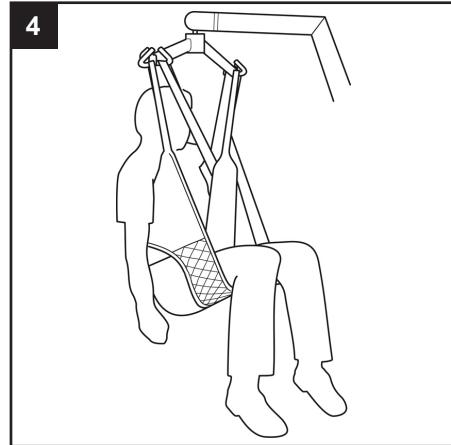
Legen Sie die Beingurte über Kreuz und befestigen Sie sie mit der längsten Schlaufe an den vorderen Haken des Spreizbügels. Heben Sie den Patientenlifter an und befestigen Sie die gewünschte Schulterschlaufe am hinteren Haken (mit der kürzesten Schlaufe erzielen Sie eine aufrechte Haltung).
