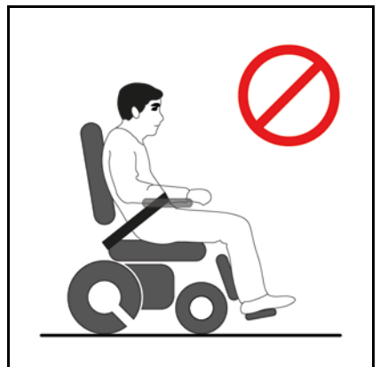
Figure 4.20 : position incorrecte de la ceinture
